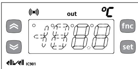
Ao acender o instrumento este efectua um Lamp Test; por alguns segundos o display e os leds entram em intermitência, para a verificação da integridade e do bom funcionamento dos mesmos. O instrumento dispõe de dois Menus principais, o Menu “Estado Máquina” e o Menu de “Programação”.
